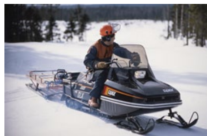
Lynx GLX 5900 var en revolutionerande modell för skoterbranschen. Det var den första bredbandade modellen som kombinerade de bästa egenskaperna hos både fritids- och nyttskotrar.
